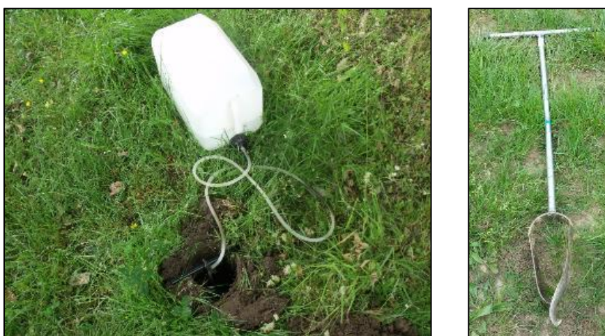
Photographie 2 : Matériel utilisé pour la réalisation des tests d'infiltration de type Porchet
